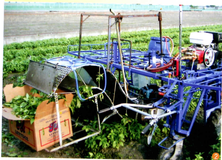
↓圖2. 西螺農民自行研發的採收機大大提高採收速率及降低損耗
