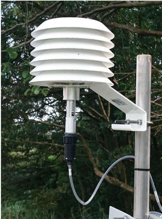
▲圖5、林務局林火預警自動化測站－溫、濕度測量器
