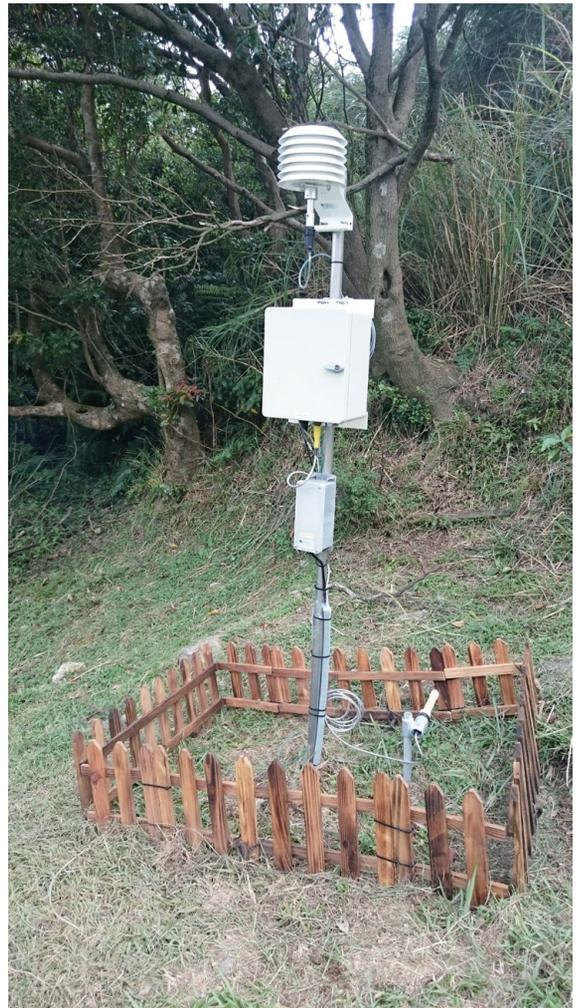
▲圖4、林務局林火預警自動化測站，各林管處選擇能涵蓋轄區範圍內的適當地點設置。
