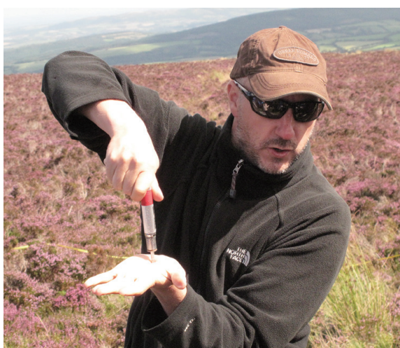
▲圖16、中心教師示範說明土壤硬度計使用方法
