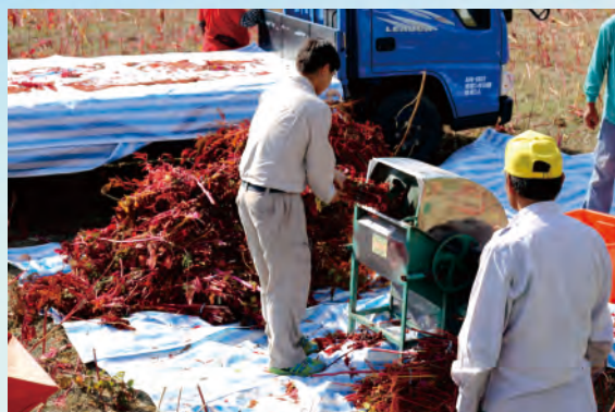
圖5. 水稻脫粒機可直接將捆紮好的臺灣藜果穗於田區進行快速脫粒
