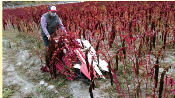
圖2. 應用水稻捆紮機進行臺灣藜收穫可提升採收速度
