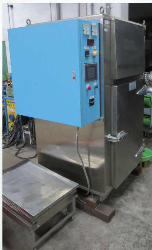
圖四、低溫除濕乾燥機
