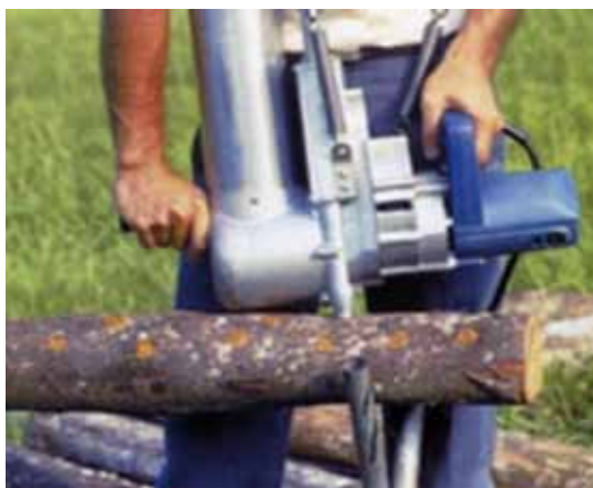
圖八、1980-1990年代，用段動植菌機，植菌情形。
