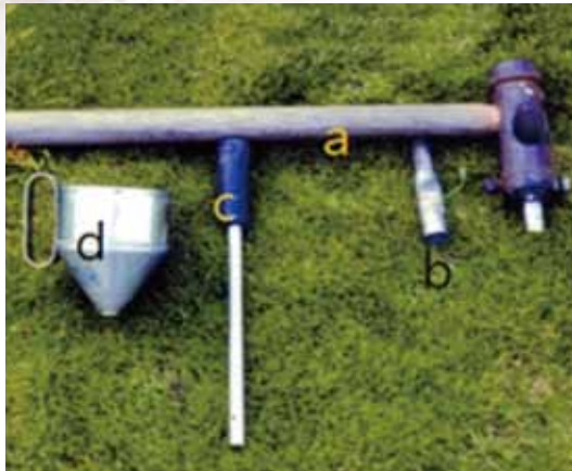
圖一、1960-1980年代植菌工具 (a.打孔器；b.取蓋器；c.植菌棒 d.植菌漏斗)。
