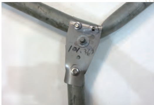
▲新樣式管夾拉力試驗結果
