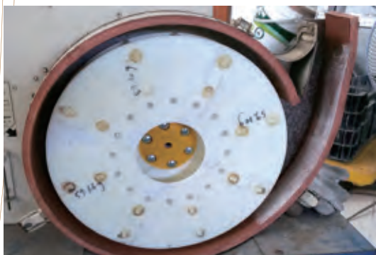
▲新型專利～脫殼機離心盤體結構改良
