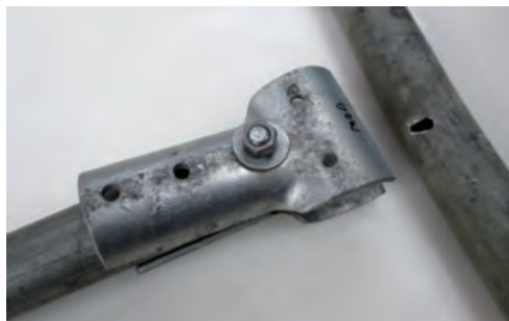
▲螺絲組裝數不足之管夾組件
