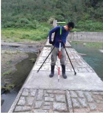
圖 5 即時衛星動態定位測量 (RTK-GPS)
