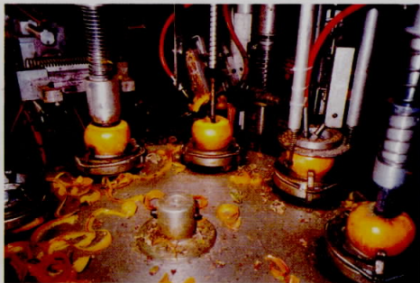
柿子削梗、修蒂、蒂邊緣先行削皮 及吸附等一貫自動化作業情形
