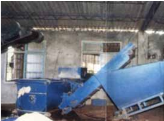
圖十八、配料。本圖為輸送帶將篩過之木屑，送到機械混合槽，經充分混合後，再經另一輸送帶送出之設備。所需配料，除木屑外計有：適量的水、米糠或粉頭等。
