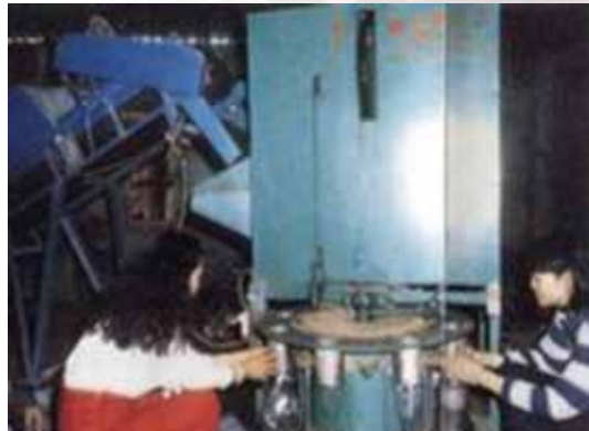
圖十九、裝袋壓包。本圖為另一輸送帶，將混妥之材料，送入壓包機存料口，及壓包機壓包之操作。壓包機，早期採用電動單座型，每台工作量3000包/天；此一半自動旋轉型者，可達7000包天左右。
