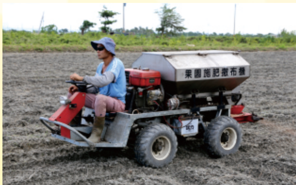
圖2.使用市售乘坐式果園施肥撒布機進行臺灣藜田區施肥可提升速度和減輕勞力負擔
