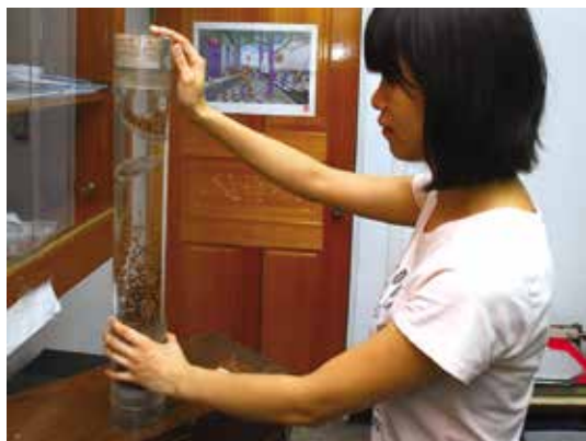
圖4 細小質輕的種子可用風選機來篩選汰除輕粒與雜質 (楊正釧 攝)
