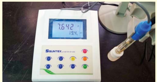
圖二、土壤pH值的測定—電極法（農民可自行採樣，送區改良場免費檢測）。
