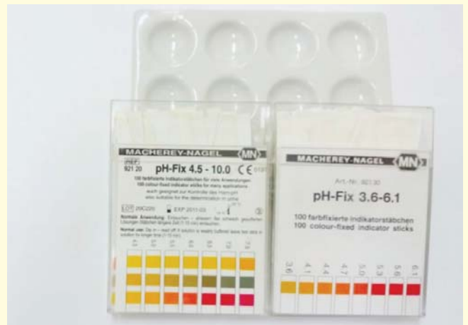
圖一、土壤pH值的測定—比色法（農民可至化工原料行購買試紙，以水彩調色盤和純水自行比色定）。
