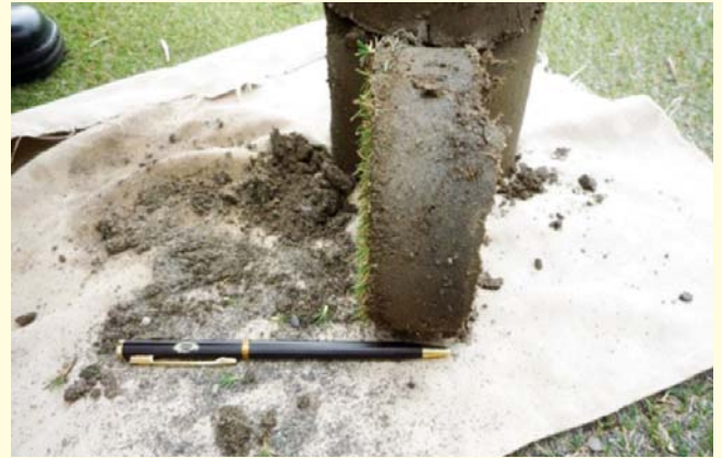
圖十五、土壤顏色為灰藍(grey)色，是土壤發生還原的證據，也就是說土壤中曾經有一段時間為積水，如果去觸摸顏色轉換的交接面，你會發現土粒顆粒大小不一，這是造成土壤排水不好的原因，也是草皮生長不良的原因，難怪草的根只長在表土2-3公分（根據右圖推測）。
