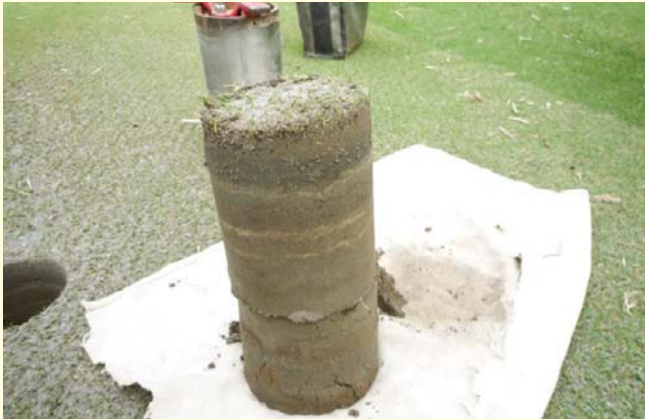
圖十五、土壤顏色為灰藍(grey)色，是土壤發生還原的證據，也就是說土壤中曾經有一段時間為積水，如果去觸摸顏色轉換的交接面，你會發現土粒顆粒大小不一，這是造成土壤排水不好的原因，也是草皮生長不良的原因，難怪草的根只長在表土2-3公分（根據右圖推測）。
