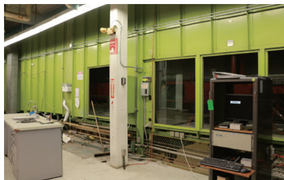
▲圖2、低速風洞，正方形斷面邊長為3.12公尺，最大風速可達每秒3.12公尺。
