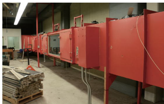
▲圖1、高速風洞，正方形斷面邊長為0.91公尺，最大風速可達每秒17.88公尺。
