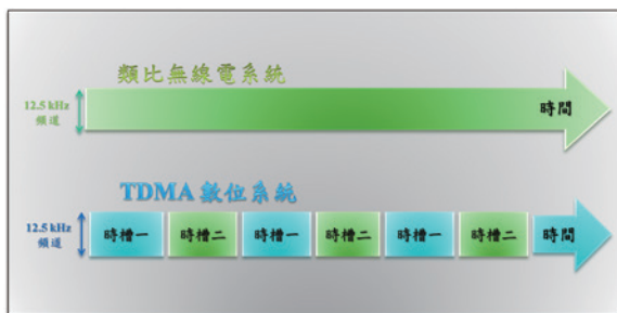
▲圖4、TDMA數位無線電系統，將現有12.5kHz頻道分為兩個時槽，透過轉播機提供2倍之使用能量，並可以同時支援語音或資料之傳輸。
