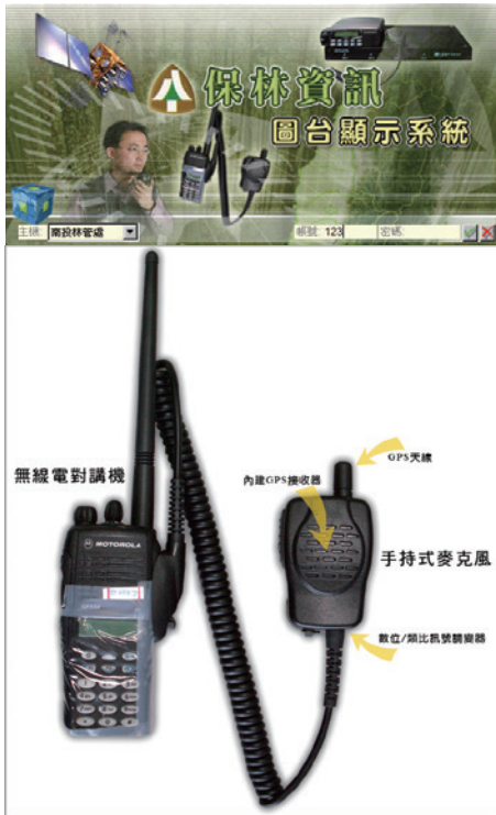
▲圖2、2006年建置之保林資訊圖台顯示系統，護管人員除應攜帶無線電對講機外，需外掛合電池之GPS手持麥克風。
