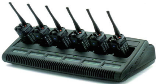
▲圖9、智慧型能源系統具備自動重調整功能，使手機電池可長期保持最佳狀態，並能監測電池狀況及品質分析，降低保養維護之人力與成本。
