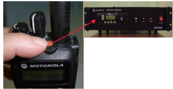
▲圖6、遇緊急狀況發生時，按下手機上方紅色緊急按鈕，話機自動轉換成聲控功能，將使用者ID及現場語音傳送至監控台並以簡訊通報值班人員或管理者，以利救援或處理。
