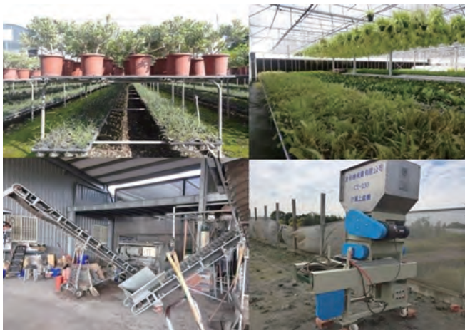
班利用露天苗床(左上)與立體化栽培提升空間利用率(右上)，使用輸送機(左下)與自動上盆機(右下)提升作業效率
