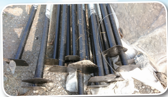
圖 2. 立柱基部入土部分採柏油防鏽處理
