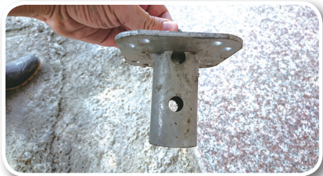
圖9. 管帽上方有8個鋼索夾孔以供夾鋼索；下方接口可插入鉸管並穿入螺絲固定(旺田溫室設備公司設計)
