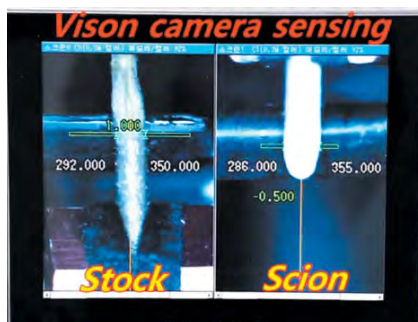
圖 3. 韓國 AFGR-800CS 嫁接機應用影像辨識系統量測穗砧苗切口面尺寸
