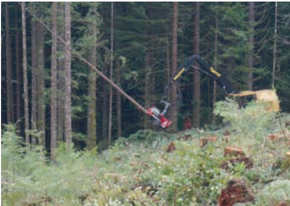
▲ 一名技術人員即可操作收穫機執行伐木及集材，大幅降低人工工資及作業風險。
