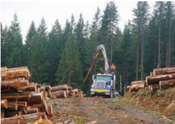
▲ 運材卡車司機以附設夾具將長材搬至車上
