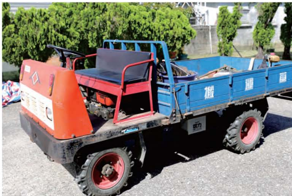
圖1. 傳統農用搬運車使用柴油引擎作為動力產生源
