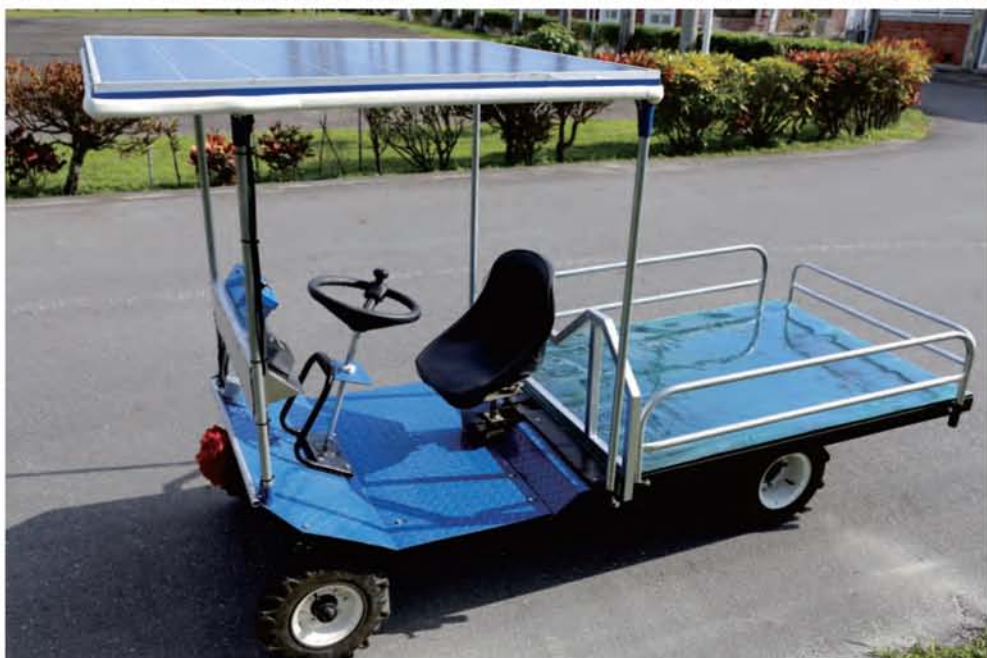
圖2. 本場研製二輪驅動太陽能電動搬運車
