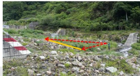
圖 12 以雷射測距儀量測溪床坡度案例示意圖
