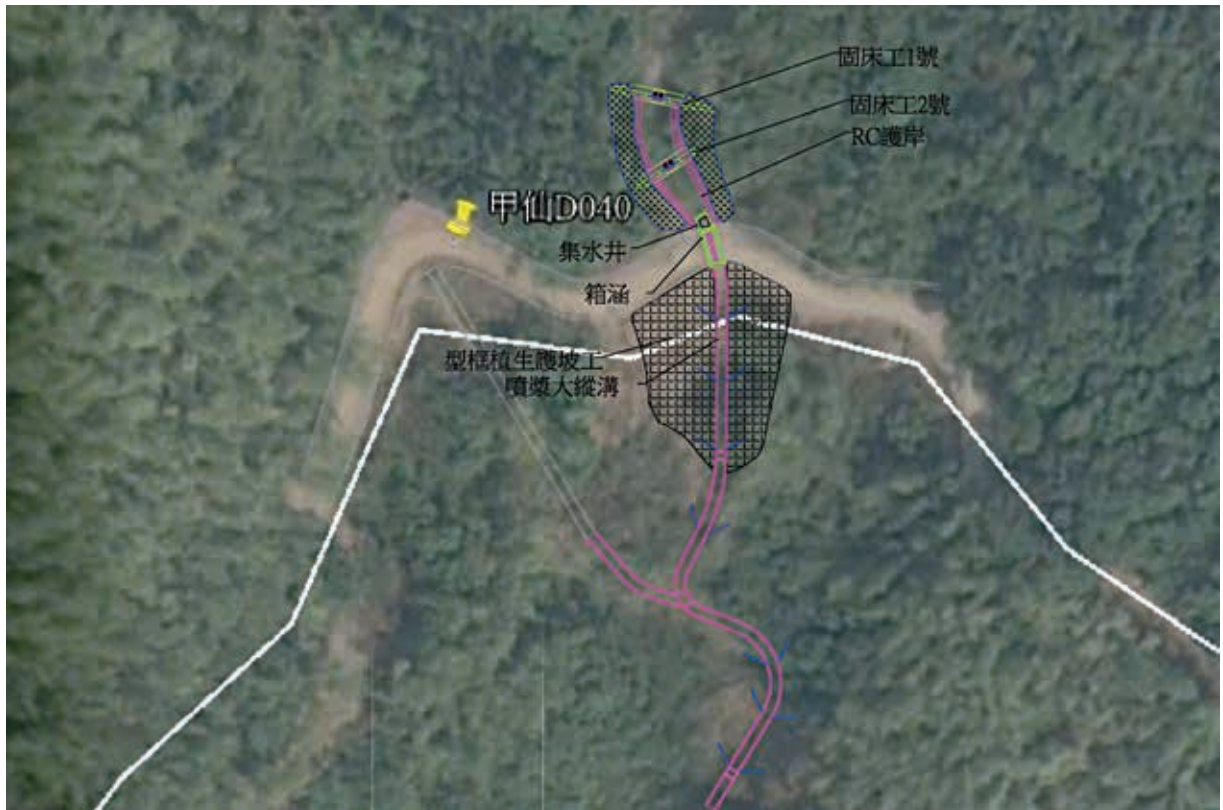
▲圖11、衛星影像套疊工程配置圖
