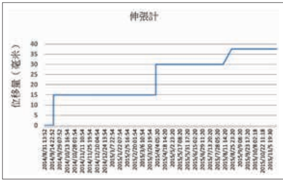
▲圖9、高雄市甲仙區-D044、D047地表伸張計變化歷程
