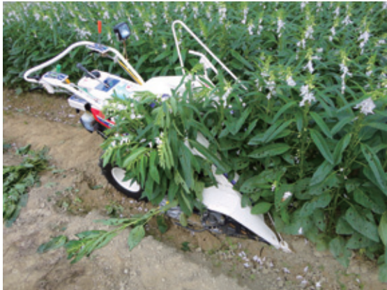
① 自走式割捆機原廠機型 ② 行走裝置改良機型
