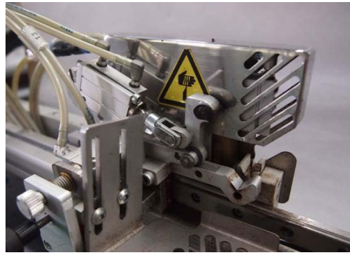
圖五、砧木斜切及定位機構
