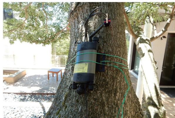
檢測樹木健康狀況，除了目視診斷，也可以結合科技儀器。例如使用樹液流動儀，可了解維管束樹液流動狀態，應用於評估了解樹木健康情形。
