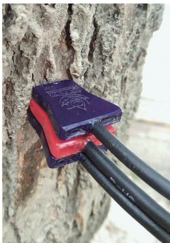
樹液流動儀藉由中央紅色探針進行加熱，上下方探針感測溫度變化速度，溫度升降快慢受樹液流速影響，經試驗在早上10點至下午2點是最佳檢測時機。
