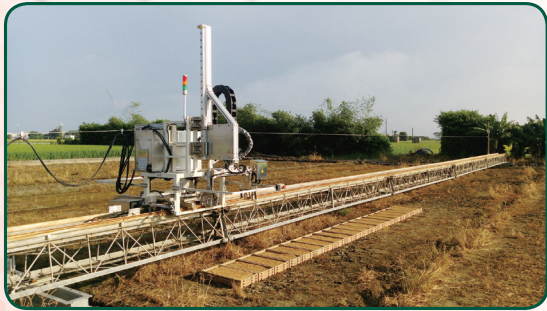
▲「智慧輕量化機械手臂」- 水稻秧苗盤機械手臂取卸系統（新型專利M566973）
