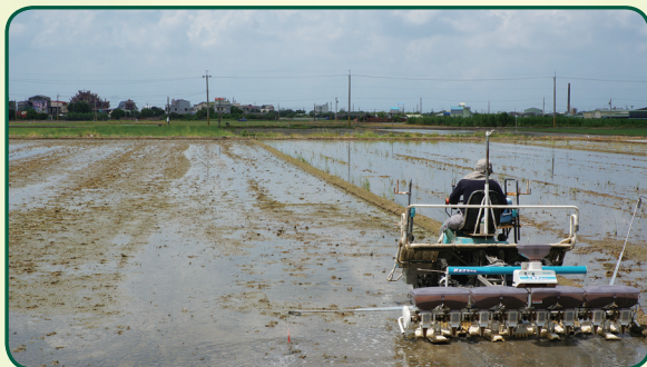
▲ 利用水稻專用湛水直播機進行播種，行株距與插秧法相近，有利於後續管理
