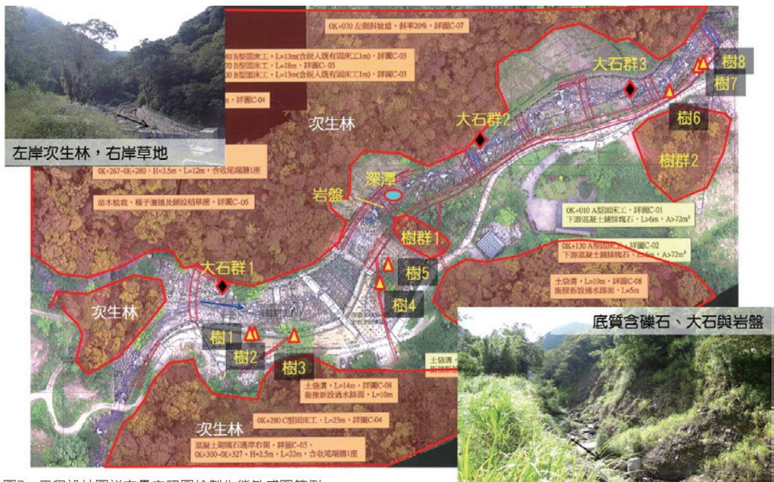
圖7、工程設計圖說套疊空照繪製生態敏感圖範例。
