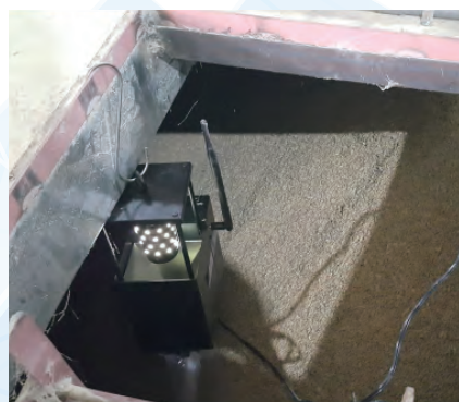
▲ 智能防蟲糧倉管理系統糧倉中利用LED誘殺器的誘殺及回傳（農試所提供）
