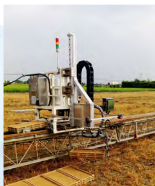
▲ 水稻秧苗盤機械手臂取卸系統（農糧署提供）
