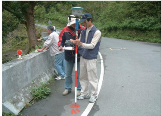
衛星定位測量儀。
