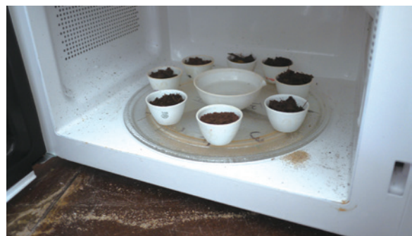
將土壤盛裝於坩鍋內，以微波去除水分，得到土壤乾重。
