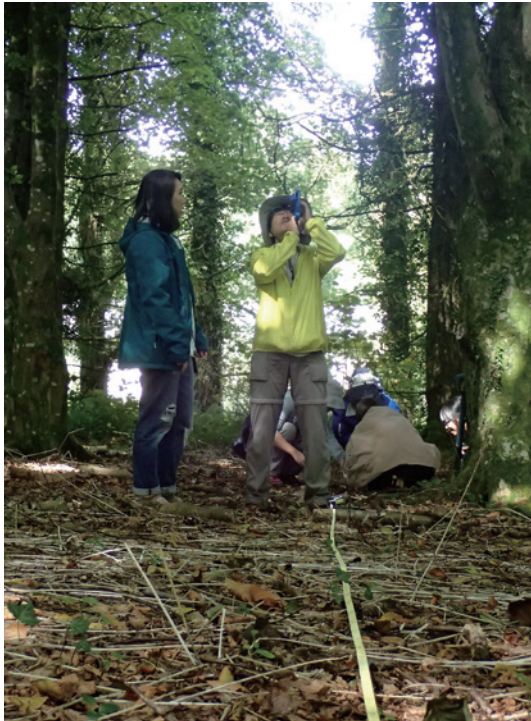
利用傾斜儀量測樣木的樹高。
