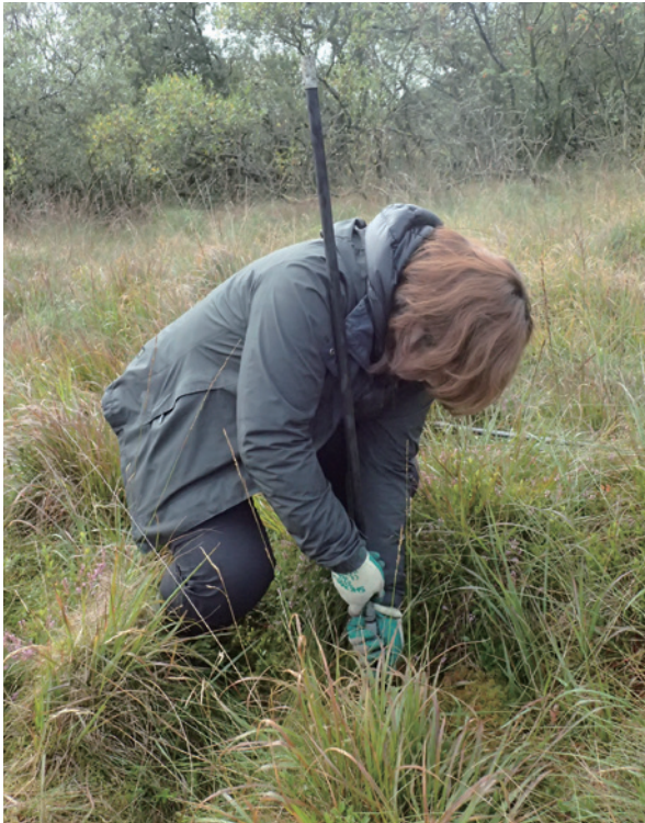
插入與拔出深度測量桿時非常耗費力氣，可戴手套輔助，並需注意施力姿勢，慎防拉傷腰背肌肉。
