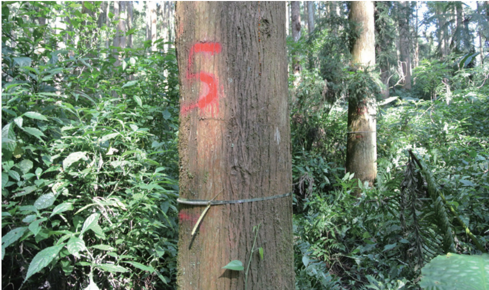
圖2、利用林木胸高直徑生長測量儀（dendrometer），進行溪頭柳杉人工造林地個別林木與整體林分的生長觀察。
