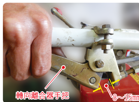
圖8. 轉向離合器間隙
