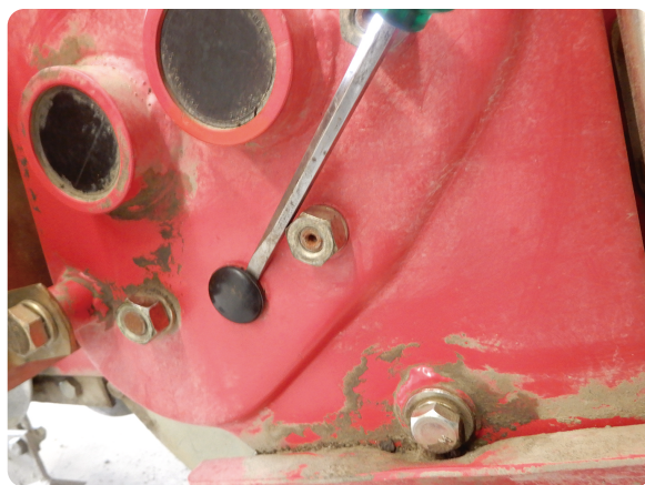
圖5. 行走部鏈輪箱加油孔
