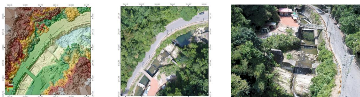
(a) DSM 暈渲圖 (b) 正射影像圖 (c) 三維模型 (以 97S-WF-2-L10-009 抽藤坑溪(中興街 33 號)災害復建工程為例)
