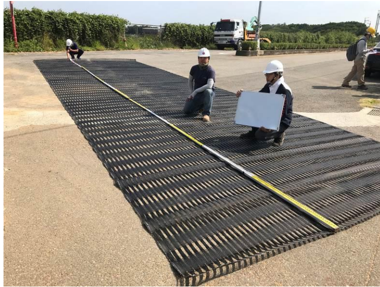
圖 2-3-6 長尺度之尺度攝影採用工具接續方式(L=12m)
