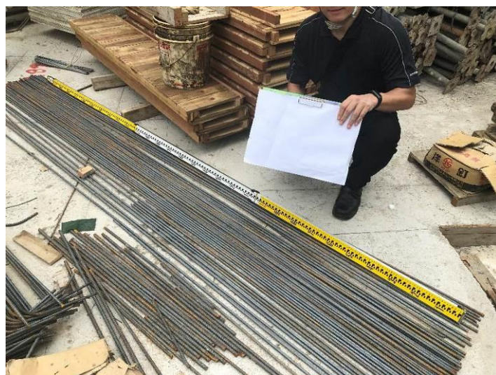
圖 2-3-5 尺度攝影連續性正確樣態
