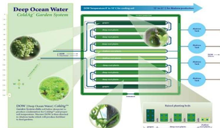
圖 3. 低溫農業技術之基本牽涉在經降溫的土壤中（係以內部通有低溫海洋水之管線進行土壤冷卻）種植作物。(From Common Heritage Corporation)
