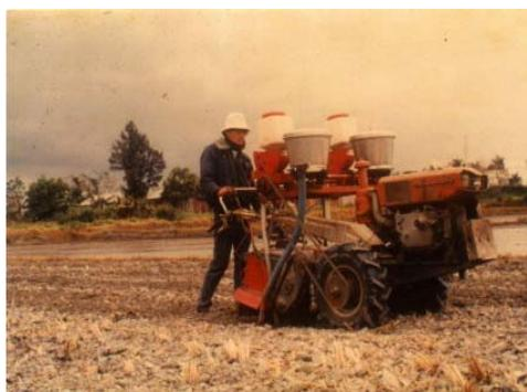
圖 3. 耕耘機局部整地玉米播種施肥機
