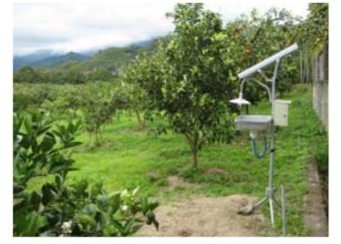
圖 18. 溺水式太陽能捕蟲器。
