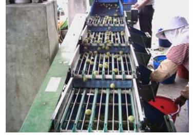
圖 10.二輪傳動果樹施肥撒 圖 11. 氣壓式青梅採收機。 圖 12. 青梅粒徑分級機。
