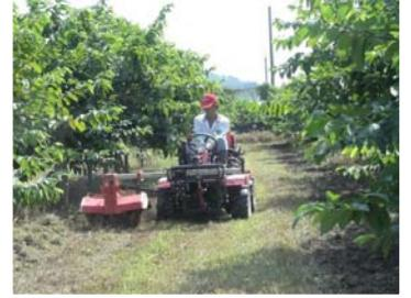
圖 15. 果園側移中耕除草機中耕作業。
