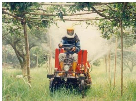
圖 4. 坡地多用途作業機(附噴藥機型)
