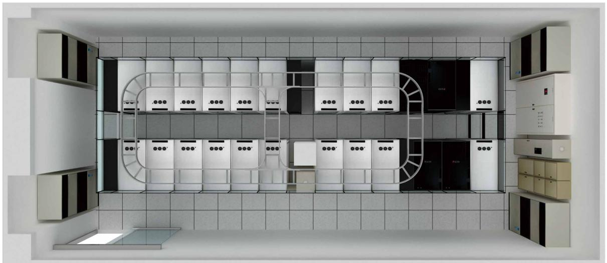
圖4、林務局電腦機房冷熱通道設計圖。
