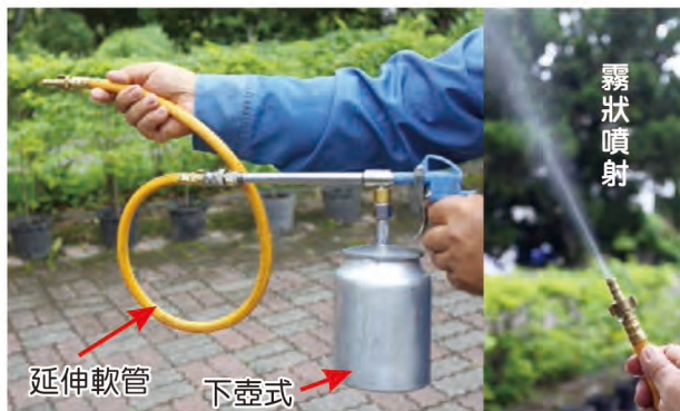
圖6.噴漆槍頭以高壓軟管延伸方便操作
