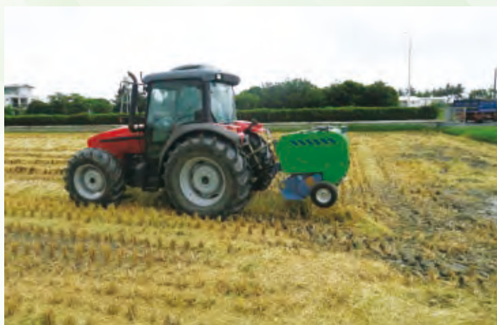
圖1. 小型稻草打包機田間作業情形
