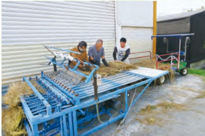
圖2. 稻草編織機作業情形
