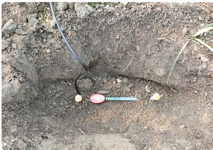
圖5. 土壤濕度計埋設在土壤中
