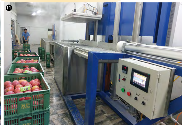
9 愛文芒果經溫湯處理後於冷卻水槽降溫 10 11 新型6籃機台
