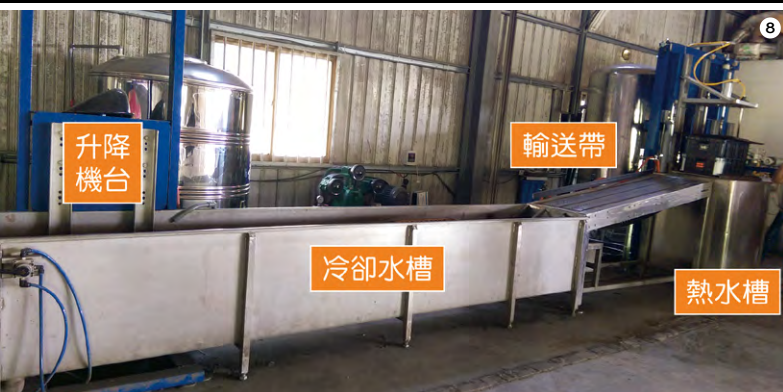
7 愛文芒果經60°C溫湯處理30秒後明顯抑制炭疽病發病 8 溫湯處理設備
