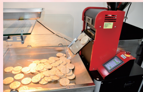
利用膨發壓餅機製作原味糙米餅之情形
