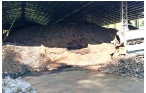
圖一、香菇包回收場，回收香菇包脫塑膠袋和堆置於暫存區之情形。
