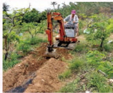
開溝施用石灰資材或鹼性生物炭以改良酸性土壤
