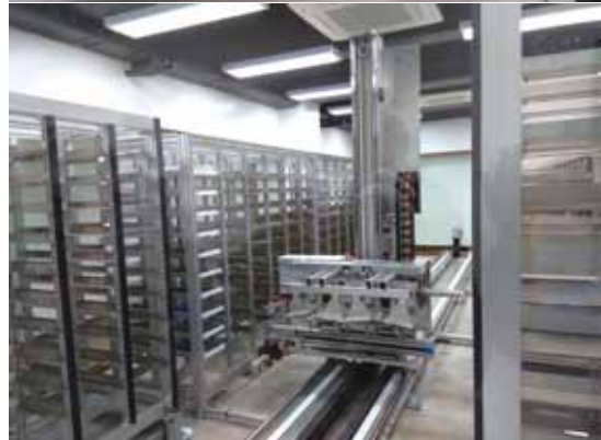
圖五、自動化檢測發芽率之發芽盤(上)與發芽設施(下)，每個發芽盤可放置50顆種子，一次可放置720組發芽盤，放於發芽室後可自動拍攝影像，紀錄種子逐漸發芽情形。
