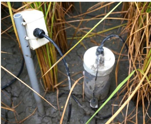
圖二、田間水位感測器，可即時反應田間水位深度。
