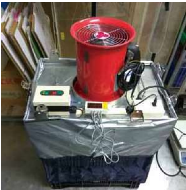
圖五、「頂吸式壓差預冷設施」實機。
