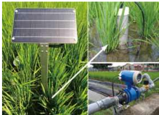
圖一、導入太陽能水位計、電子流量計等田間感測設備。
