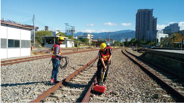
圖6、透地雷達進行鐵道噴泥檢測。(攝影/郭治平)
